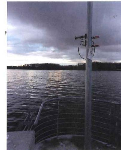
Figure 3. Installation de la campagne d'acquisition du 22 novembre 2013. On remarque l'antenne, fixée avec son axe horizontal pointant vers le lac.
