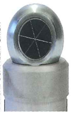
Prisme réflecteur monté dans une sphère, précision 0,1 mm.
