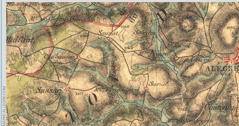
Sur la carte d'état-major (ci-dessus), les hachures marquent un progrès dans la lecture des reliefs autour d'Allègre, à comparer au rendu mal lisible de celui des alentours de Sisteron, zone très accidentée, sur la carte de Cassini (en haut à gauche), alors que, sur la zone peu accidentée de Champigny, le rendu est assez satisfaisant (à droite).
