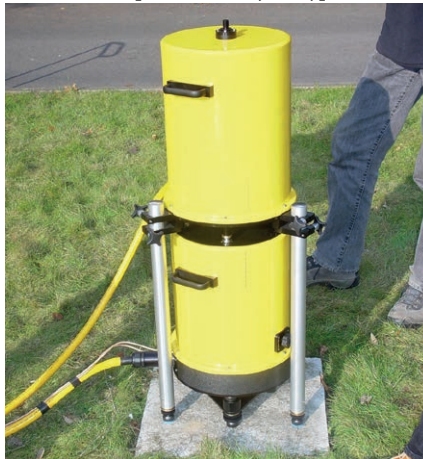
Figure 25. Mesure avec le gravimètre absolu A10 sur un RBF
