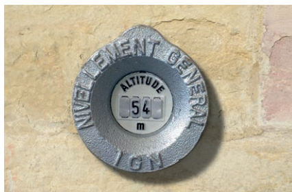
Figure 2. Repère de nivellement sur mur (IGN)
