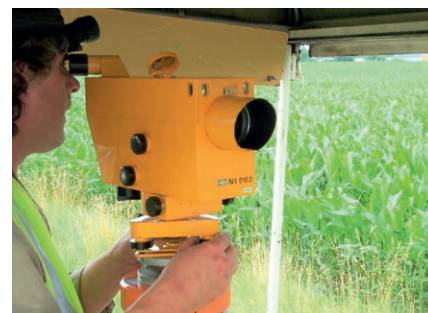
Figure 7. Équipement NIGEMO et niveau automatique Zeiss léna Ni 002
