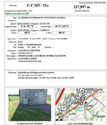
Figure 17. Fiche de nivellement (IGN)
