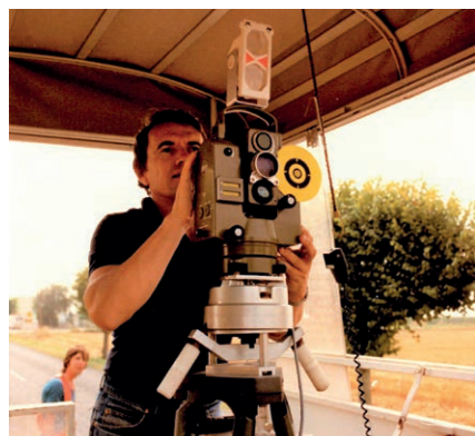
Figure 8. NITRIMO : équipement véhicules et théodolite Kern DKM2A
