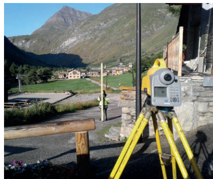
Figure 18. ERNIT, observation au niveau Trimble DINI (ph IGN)
