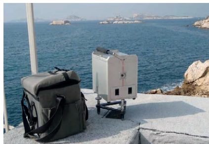
Figure 24. Mesure avec le gravimètre relatif CG5 sur le RBF du marégraphe de Marseille [Gattacceca (2011)]
