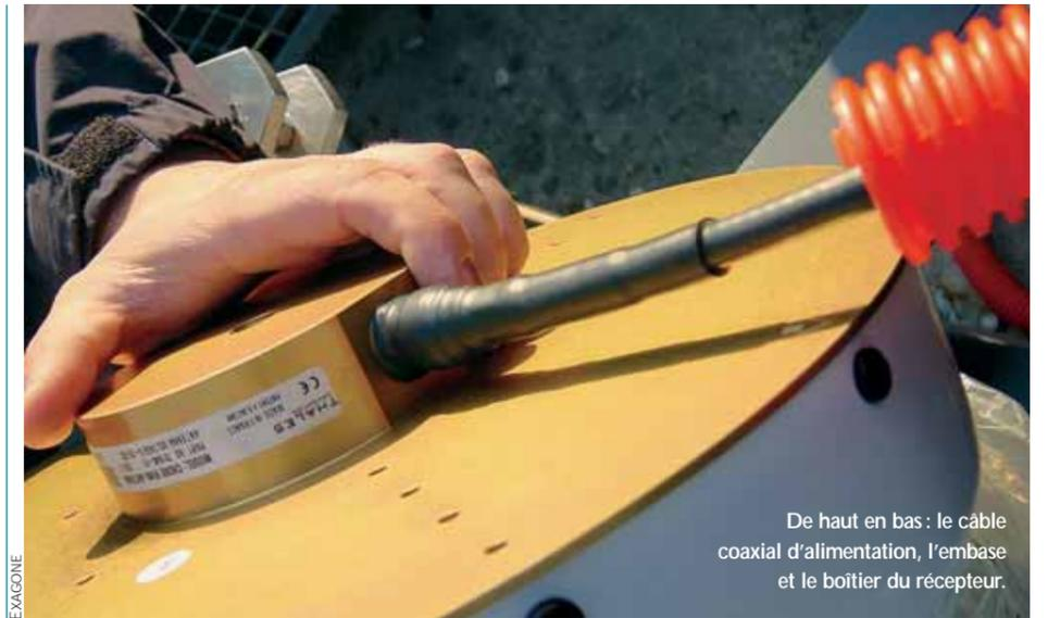
De haut en bas : le câble coaxial d'alimentation, l'embase et le boîtier du récepteur.
