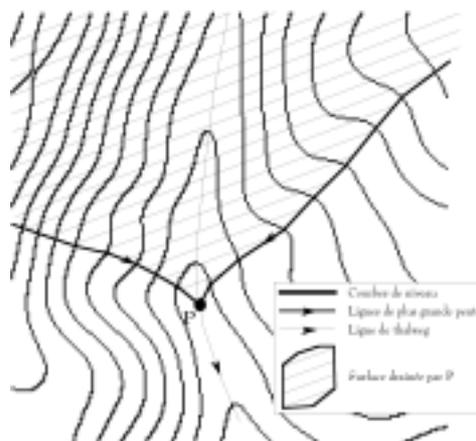
**Figure 3.61.** Bassin de réception en amont d'un point
