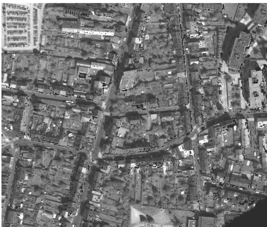
**Figure 3.41.** Ortho-image correspondant au MNS de la figure 3.40. Pixel sol de 40 cm, prise de vue numérique sur Le Mans avec recouvrements longitudinaux et latéraux de 50 %
