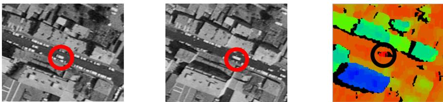
**Figure 3.30.** Artefacts dus aux véhicules mobiles. En effet, le traitement stéréoscopique suppose que les surfaces observées sont immobiles entre les deux acquisitions (voir le cahier couleur)
