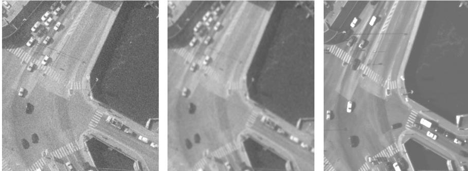
**Figure 2.10.** À droite, une image numérisée à 21  $\mu\text{m}$  sur une photographie aérienne. Les zones homogènes, bruitées, contiennent une texture aléatoire qui ne constitue pas un signal utile. Au centre, l'image originale après le filtre gaussien. Si le bruit a été atténué, les contours sont également devenus flous. À gauche, une image d'une caméra numérique : les zones sont naturellement faiblement bruitées en raison de la nature du capteur et de sa très bonne dynamique.
